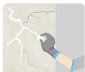
**MENGISI RETAK TEMBOK**, Untuk mengisi retak tembok berukuran kurang dari 3 mm, Anda dapat menggunakan produk exterior putty/plamir yang cocok untuk tembok eksterior.
