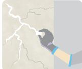
**MENGISI RETAK TEMBOK**, Untuk mengisi retakan hingga 3mm, gunakan produk penambal retakan grade exterior yang sesuai.
