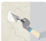
**MENGISI LUBANG dan MERATAKAN PERMUKAAN**, Jika permukaan tembok berlubang dan tidak rata, anda dapat menggunakan campuran semen putih dan pasir halus dengan perbandingan 1:3. Untuk hasil yang lebih maksimal campurkan SmartCare Semboost, waterproofing integral pada campuran semen putih.
